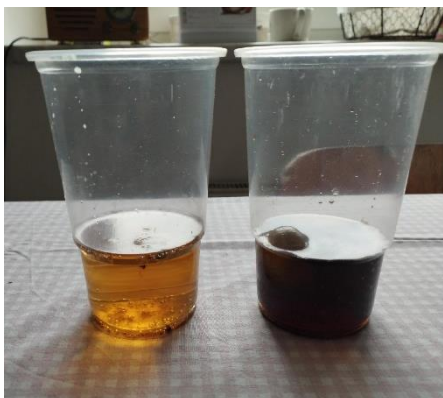
Výsledek pokusu po 24 hodinách, ulita v octu zcela rozložená (rozložila po méně hodinách), ulita v Coca-Cole nerozložená, zdroj: autorka
