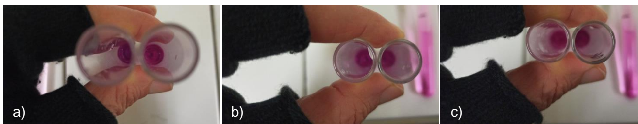
Obr. 4 Porovnávání neznámého vzorku se zkumavkami dílčí stupnice (neznámý vzorek je vždy vpravo)
